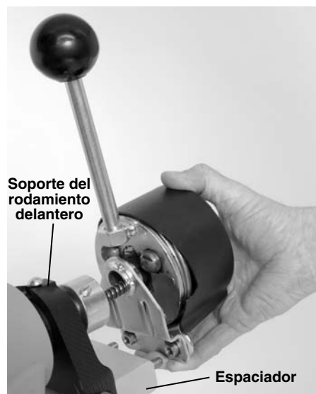
Figura 4 – Montaje del AUTOFEED a la armazón
