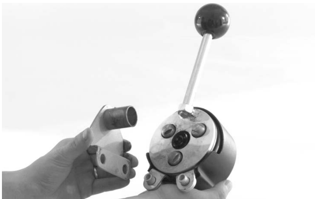
Figura 3 – Modo de colocar la pieza de montaje en el auto-alimentador
