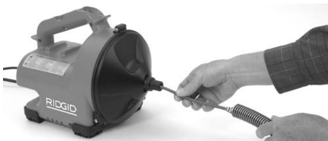
Figure 3 – Introduction du câble dans le guide-câble
