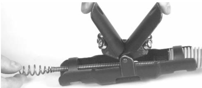
Figura 4 – Paso del cable a través de la AUTOFEED®
