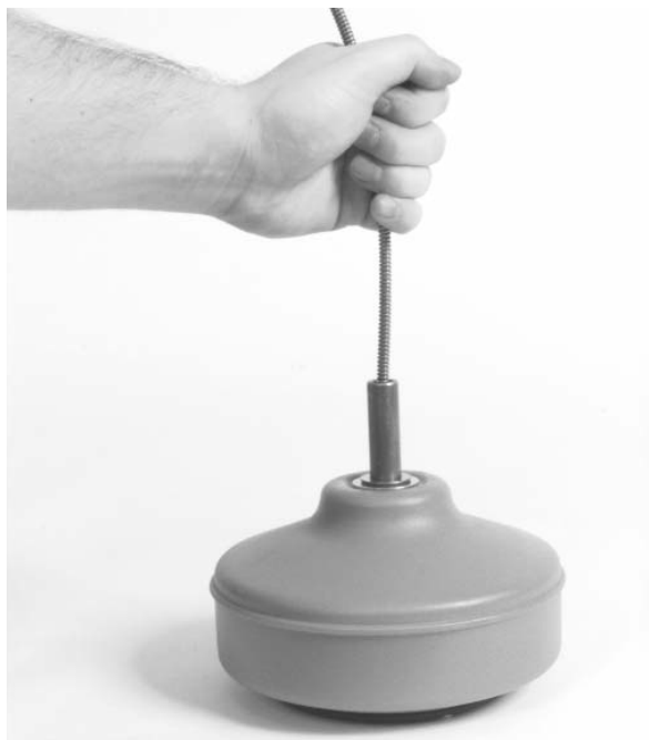
Figure 17 – Enfilage du câble dans le tambour
