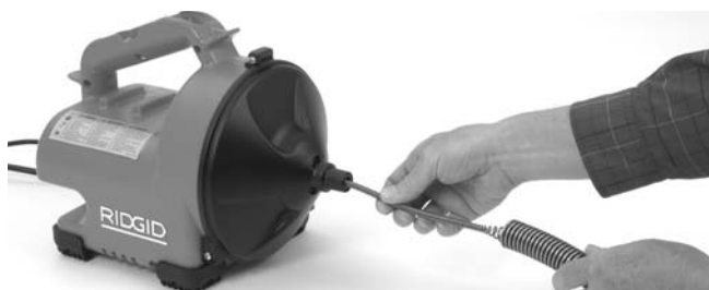
Figura 3 – Introducción del cable en la manguera guía
