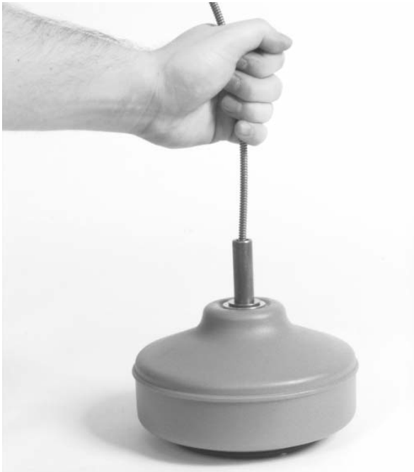
Figura 17 – Introducción del cable en el tambor
