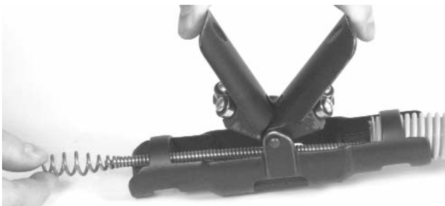
Figure 4 – Passage du câble à travers l'AUTOFEED®
