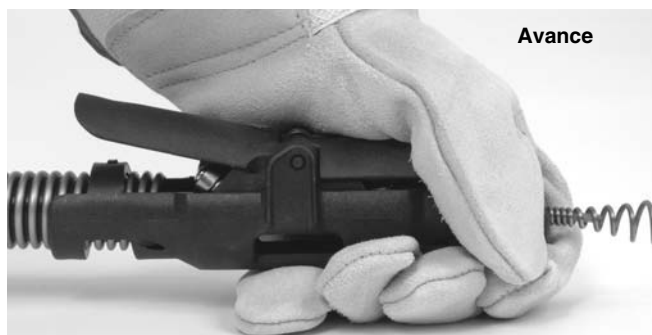
Figura 14A – La AUTOFEED en posición de Avance
