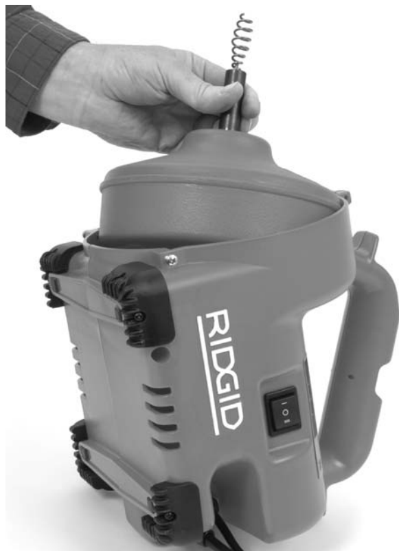
Figure 18 – Insertion du tambour dans le dégorgeoir
