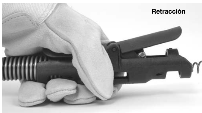
Figura 14B – La AUTOFEED en posición de Retracción
