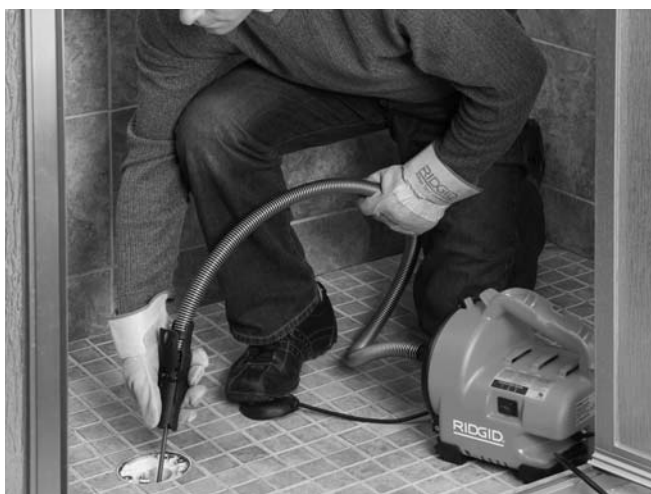
Figura 12 – Empleo de la Limpiadora de desagües con AUTOFEED
