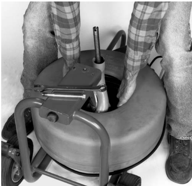
Figure 19 – Dépose du tambour
